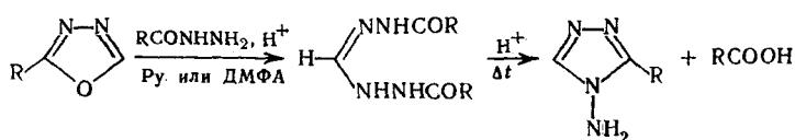
В работе<sup>63</sup> описана рециклизация перфторалкильных производных сксадиазола под действием гидразингидрата, осуществляемая в две стадии — гидразинолиз цикла (в мягких условиях) и перезамыкание в производные тетразина или аминотриазола:
